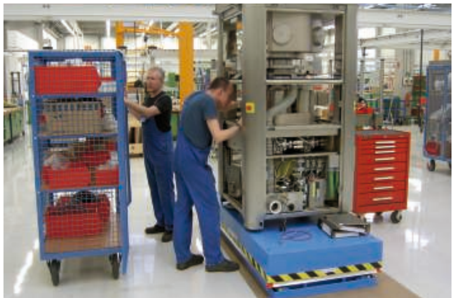
Bild 1 Produktionsgerecht kommissionierte Materialwagen am Ort der Montage bei Ima Kilian 1) in Köln.
